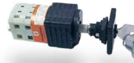
A3/10RFU+Z32 Liga-desliga, 10 amp, 4 polos, fixação furo 16mm, acionamento por fechadura.
