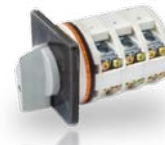
U3/115E Comutadora, 115 amp, 3 posições, 3 polos, fixação topo.
