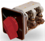
WS2/250E+FR Comutadora, 250 amp, 2 posições, 2 polos, fixação topo, manopla vermelha.
